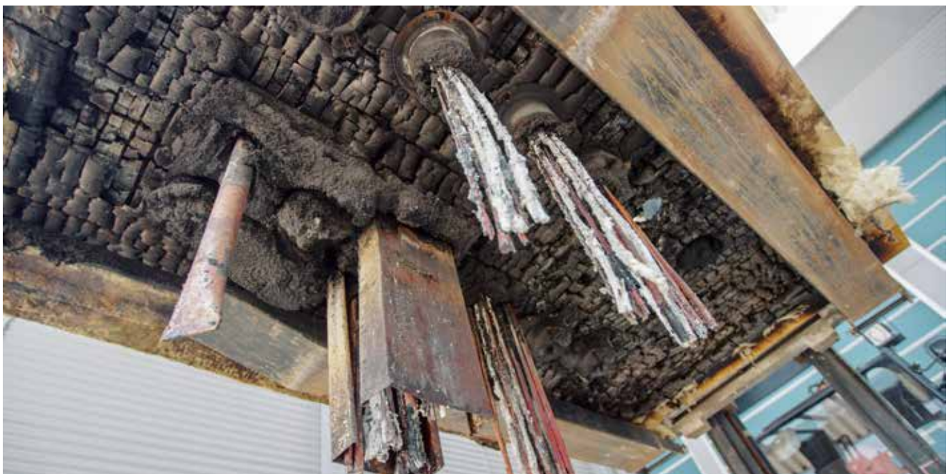
Brettsperrholz-Prüfkörper nach einer Feuerwiderstandsprüfung nach EN1366-3
