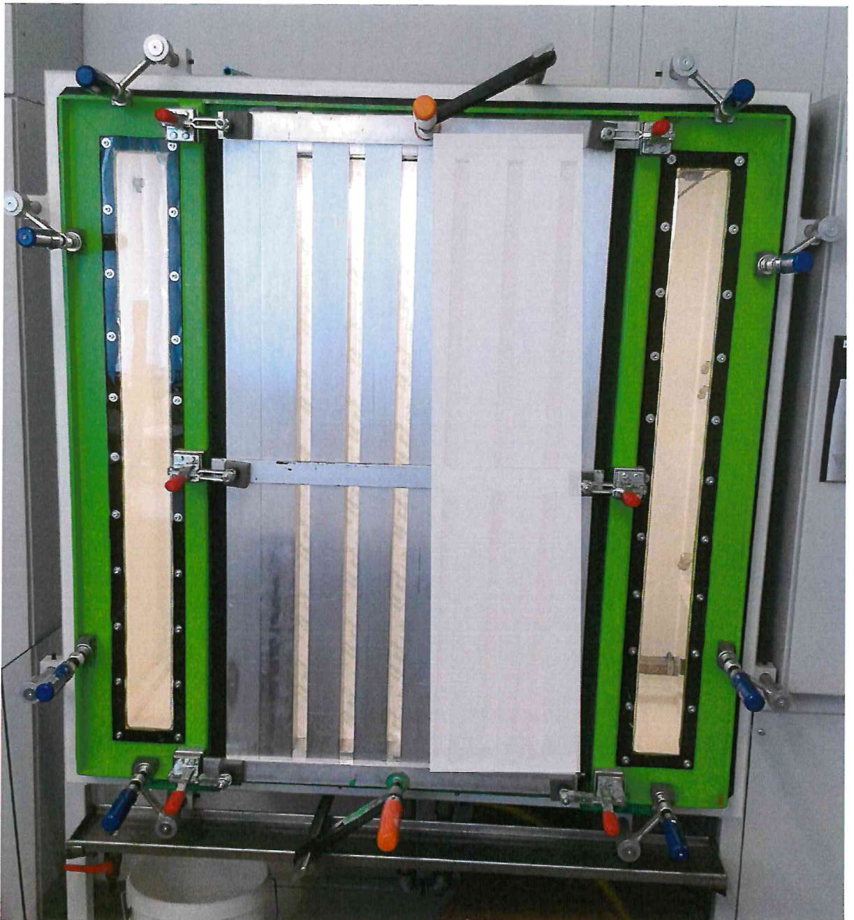
Bild 4: Prüfkörper mit der eingebauten Fugendichtungsfolie im Versuchsstand
