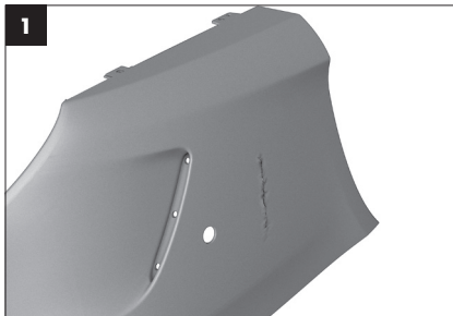
1 Riss im Kunststoffteil.
