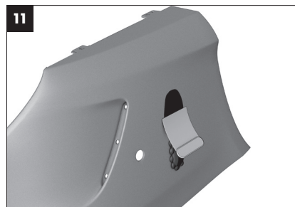
11 Klebstoff mit Spachtel und/oder Konturfolie glätten.
