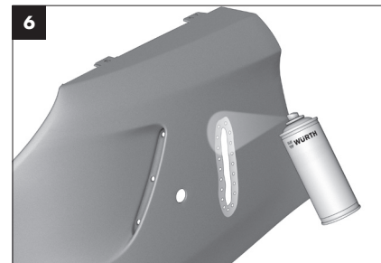
6 Primer Art.-Nr. 0893 500 2 auf der Vorder- und Rückseite auftragen. Abluftzeit beachten!
