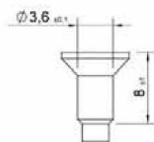
En variante aux têtes fraisées : Modification de la tige en cas d'alésage de trou de tête
