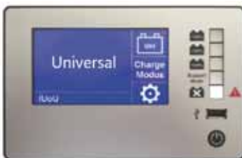
Bild 5: Manöverfält: Visar Charge Mode och Support Mode
