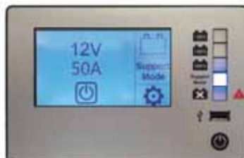
Ill. 5: Betjeningsfelt: Display med Charge Mode og Support Mode
