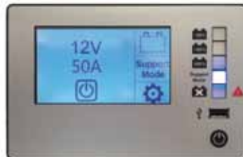
Şekil 5: Kontrol paneli: Şarj Modunu ve Destek Modunu görüntüleme
