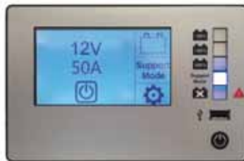
Bilde 5: Kontrollpanel: Display Charge Modus og Support Modus
