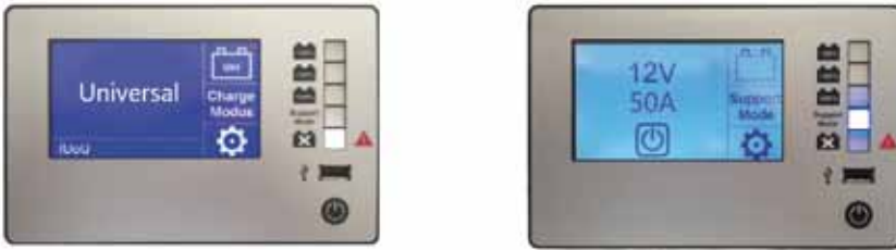
Fig. 5: Painel de controlo: Modo Display Charge e Modo Support
