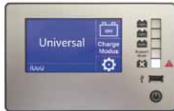
Şekil 5: Kontrol paneli: Şarj Modunu ve Destek Modunu görüntüleme
